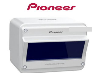
2020：3D LiDAR 第1世代モデル 4mm MEMSミラーとAPD 検出範囲：40m(人間)、70m(自動車)
