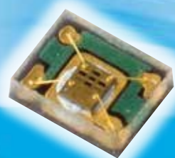
照度センサー Illuminance Sensor
